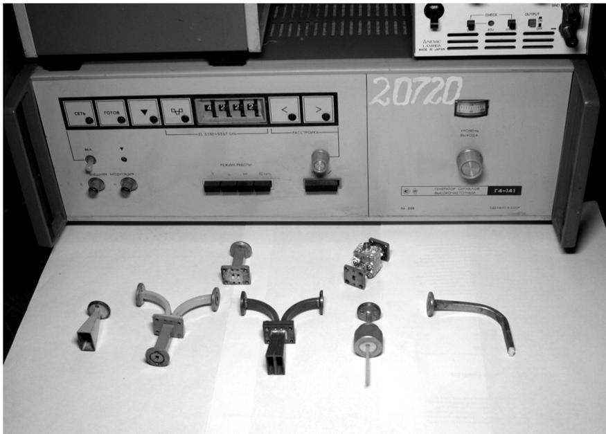
*Рис. 1.* Рупорные и диэлектрические антенны к генератору ЭМИ КВЧ Г4-141. Электромагнитные антенны представлены для сравнения, именно их заменят в «торсионных» исследованиях описанные ниже экспериментальные установки. Сравните с *Рис. 11 и 12.*
