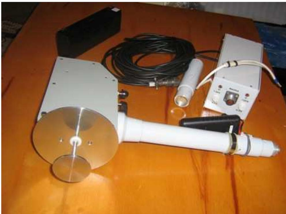
Рис. 2. ИГА-1 с полированной антенной.
