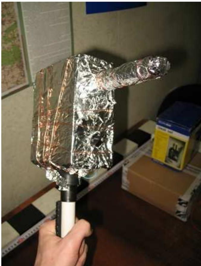
Рис. 6. Экранирование ВЕГА фольгой.
