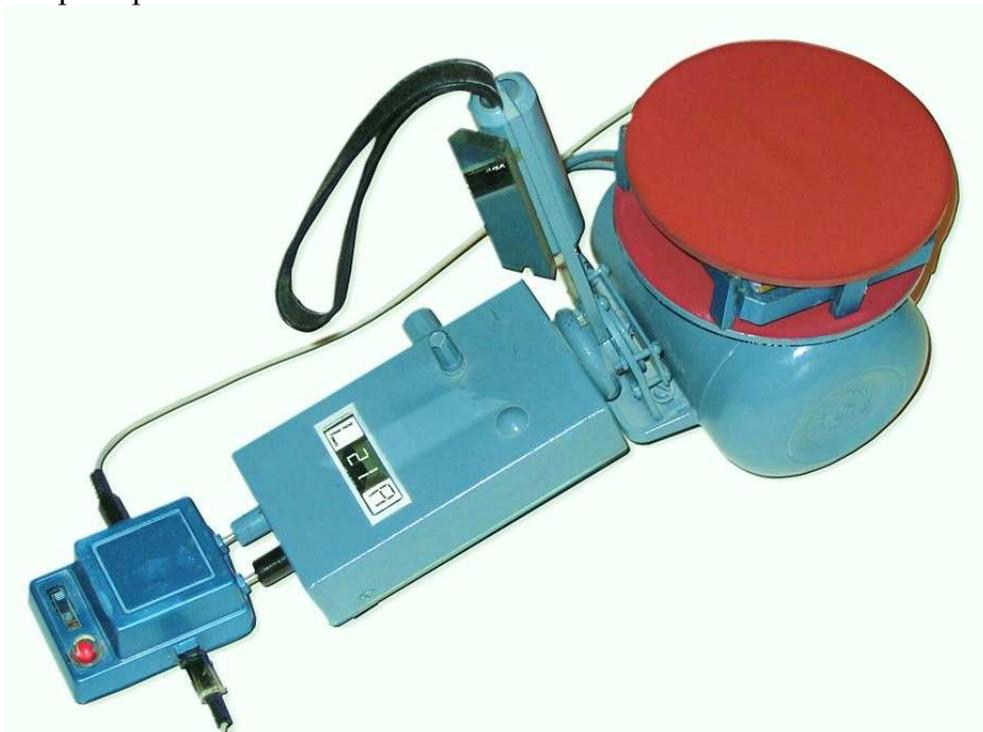
Рис. 1. Торсиммер ТСМ-021 с торсионным затвором.
