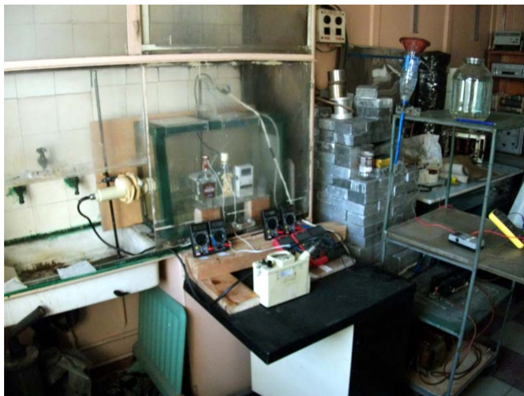
Рис. 2. Фото подготовки к работе установки Анодно Плазменного Электролиза Факел-2 (НИЦ КИ -2010-2011)
