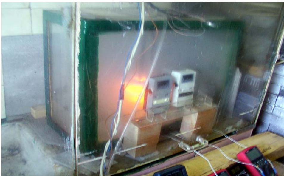
Рис. 3. Фото работающей установки Анодно Плазменного Электролиза Факел-2 (НИЦ КИ -2010-2011)
