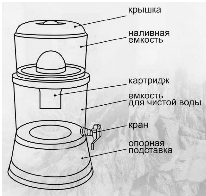
Рис. 1. Устройство фильтра «Золотая Формула ZF-5»
