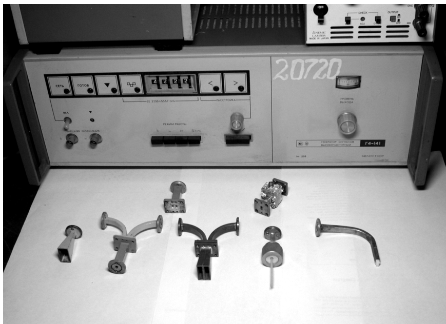
Рис. 1. Рупорные и диэлектрические антенны к генератору ЭМИ КВЧ Г4-141. Электромагнитные антенны представлены для сравнения, именно их заменят в «торсионных» исследованиях описанные ниже экспериментальные установки. Сравните с Рис. 11 и 12.
