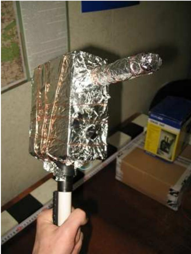
**Рис. 6. Экранирование ВЕГА фольгой.**
